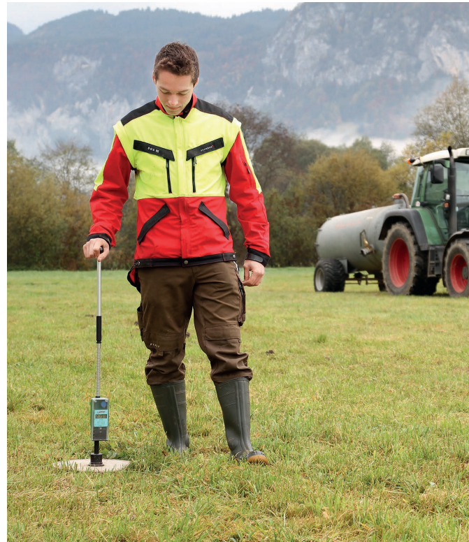
Die Wuchshöhe wurde mit einem Messgerät beim Gülle- und bei der Verschmutzungserhebung gemessen.
